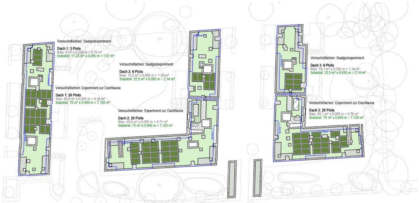
32 Detailplan Positionierung der Versuchsflächen
